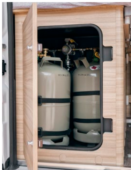
Cofre de botellas de gas para dos unidades de 11 kg (excepto CLIFF 601 con dos botellas de 5 kg)
