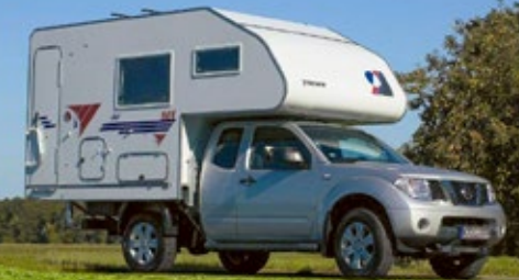
BOX 260S auf Nissan Navara, Plattform-Pritsche mit klappbaren, demontierbaren Bordwänden
